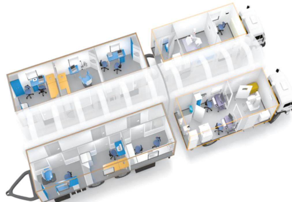
На базе шасси КАМАЗ размещается рентгенографический, флюорографический или маммографический кабинет.
