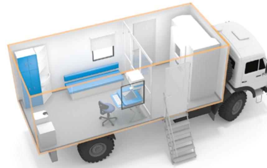
В процедурной находится цифровой кабинетный флюорограф серии **ПроСкан** или **ПроМатрикс** (наличие рентгенозащитной кабины — особенно важно, учитывая, что рентгенолог и лаборант на протяжении всего рабочего времени находятся на близком расстоянии от флюорографа).
