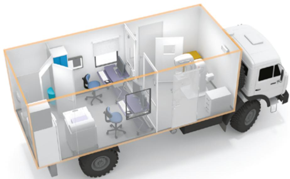
Фургон КМП-РП обладает прекрасными тепло и шумоизоляционными свойствами. Автономная дизельная система ускоренного обогрева позволяет быстро приступить к работе (30 минут для обогрева помещения и оборудования) даже при -40 °С.
